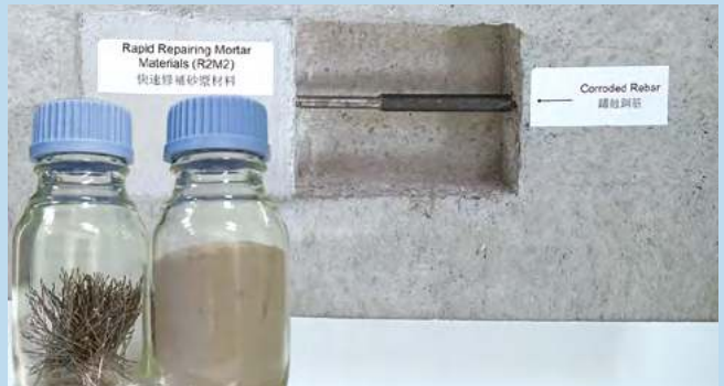
R 2 M 2 技術可以在無需搭接新鋼筋的情況下，便可補償鋼筋的承載力
