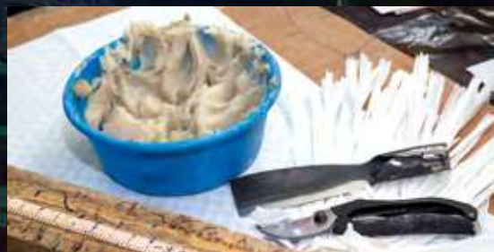
紙紮工具看似簡單，但漿糊是夏師傅自己每天煮的，尺是現時市面不再有的大陸尺寸，連刀也是手打而成的，全部是他用了多年的工具，早已產生深厚的感情
