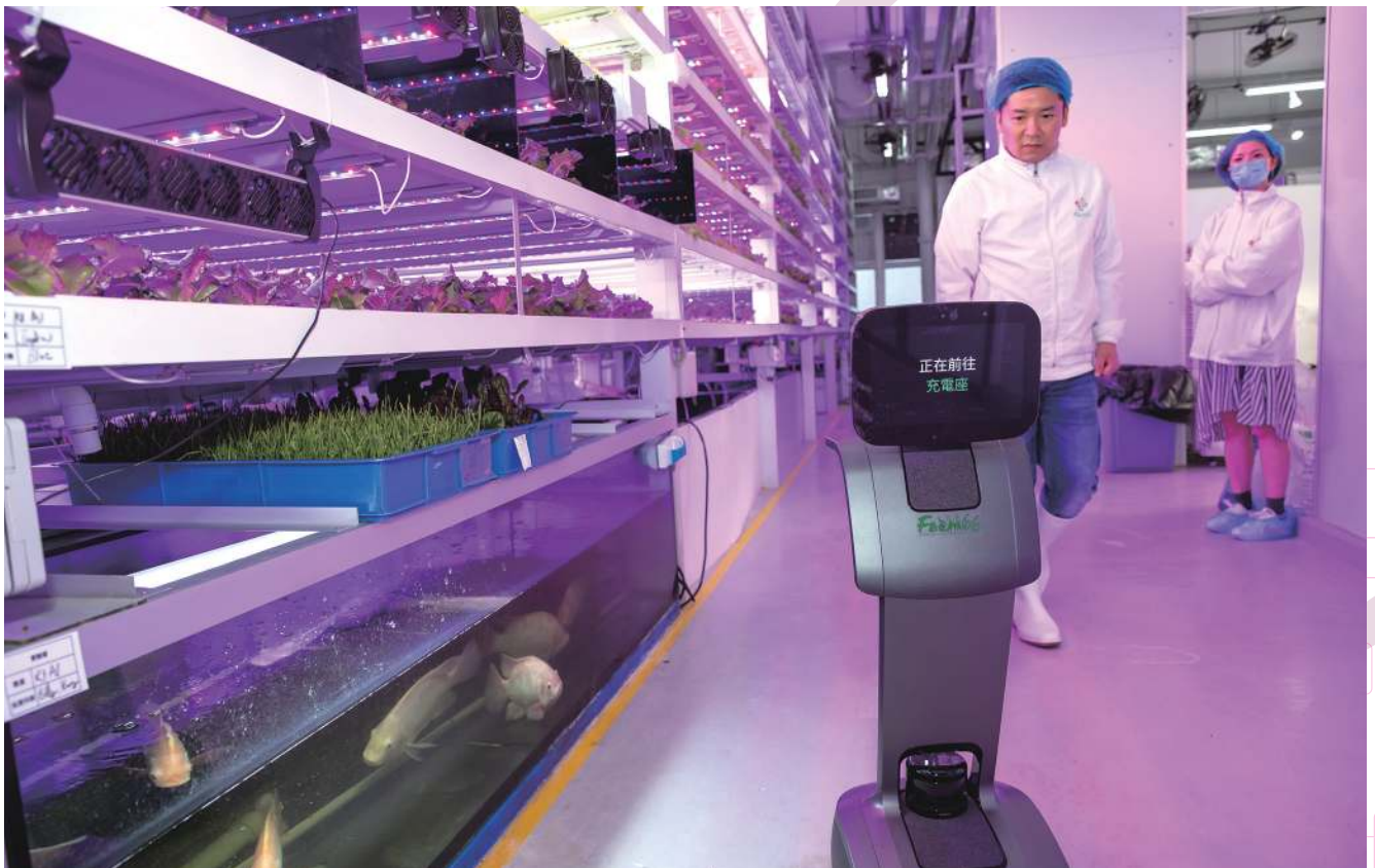
這個機械人就是 Gordon 的分身，它有幾條預先設定的路線，亦可以跟隨 Gordon 的指令到達工場不同位置，監察植物生長
