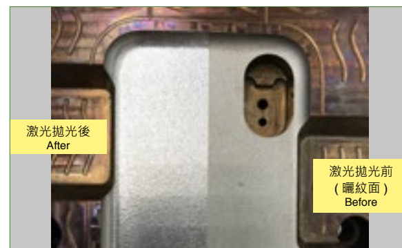
經化學蝕刻工藝處理（俗稱「曬紋」）模具在紋理上進行局部激光拋光處理 Chemical Etched Mould Local laser polishing on the texture
