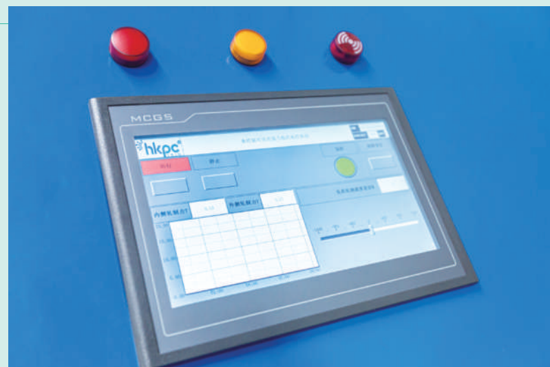
用家只需要在軋機上輸入需要的軋製下壓量和軋製速度，系統就可以自動開始整個疊軋工作。 After users input the required rolling reduction level and rolling speed to the machine, the system will automatically start the entire ARB process.
