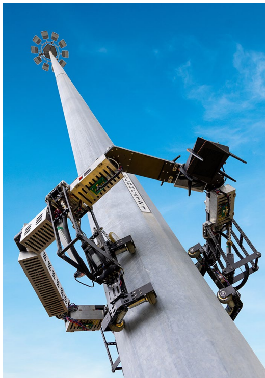
「攀影蜘蛛」運用機械人、無線通訊、人工智能影像分析及檢測技術等核心技術，推動傳統基建行業檢測及維護工作的智能化、數據化，大大提高檢測準確度、效率及安全性。
