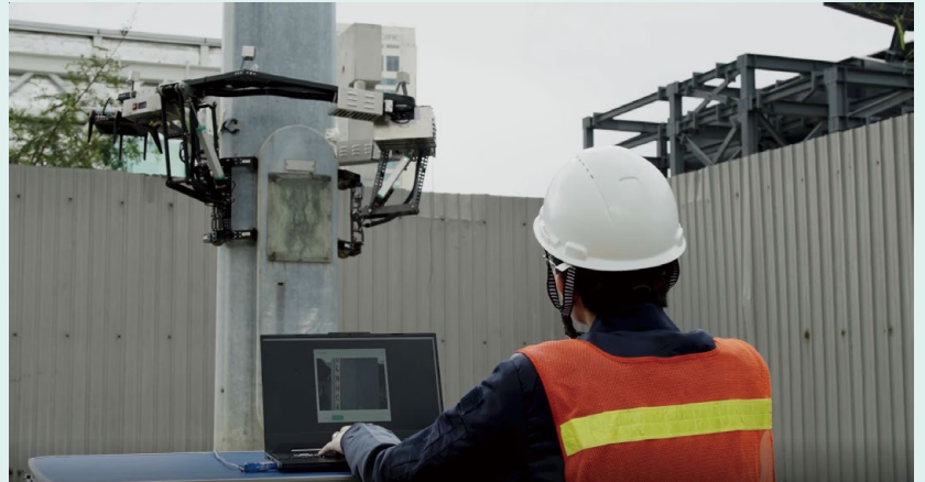
機械人靈活的運作模式令工人無需進行高空工作，能夠取代人手檢測工作，同時可以簡化傳統人手檢測所需的封路申請流程，減少因封路造成的經濟影響及不便。
