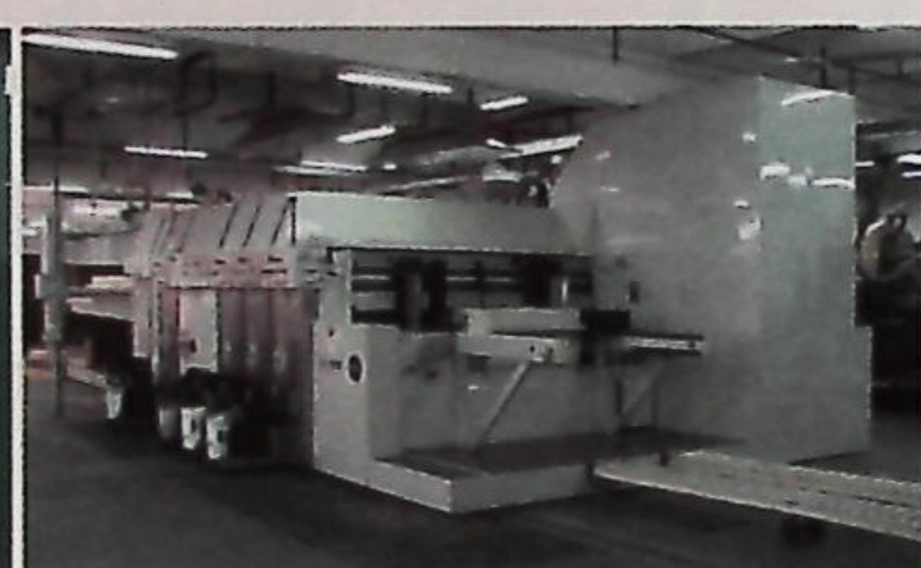
▲ 馬田四色水墨印刷機 (Martin) DRO-1628 4 Color Flexo Printer Slotter
