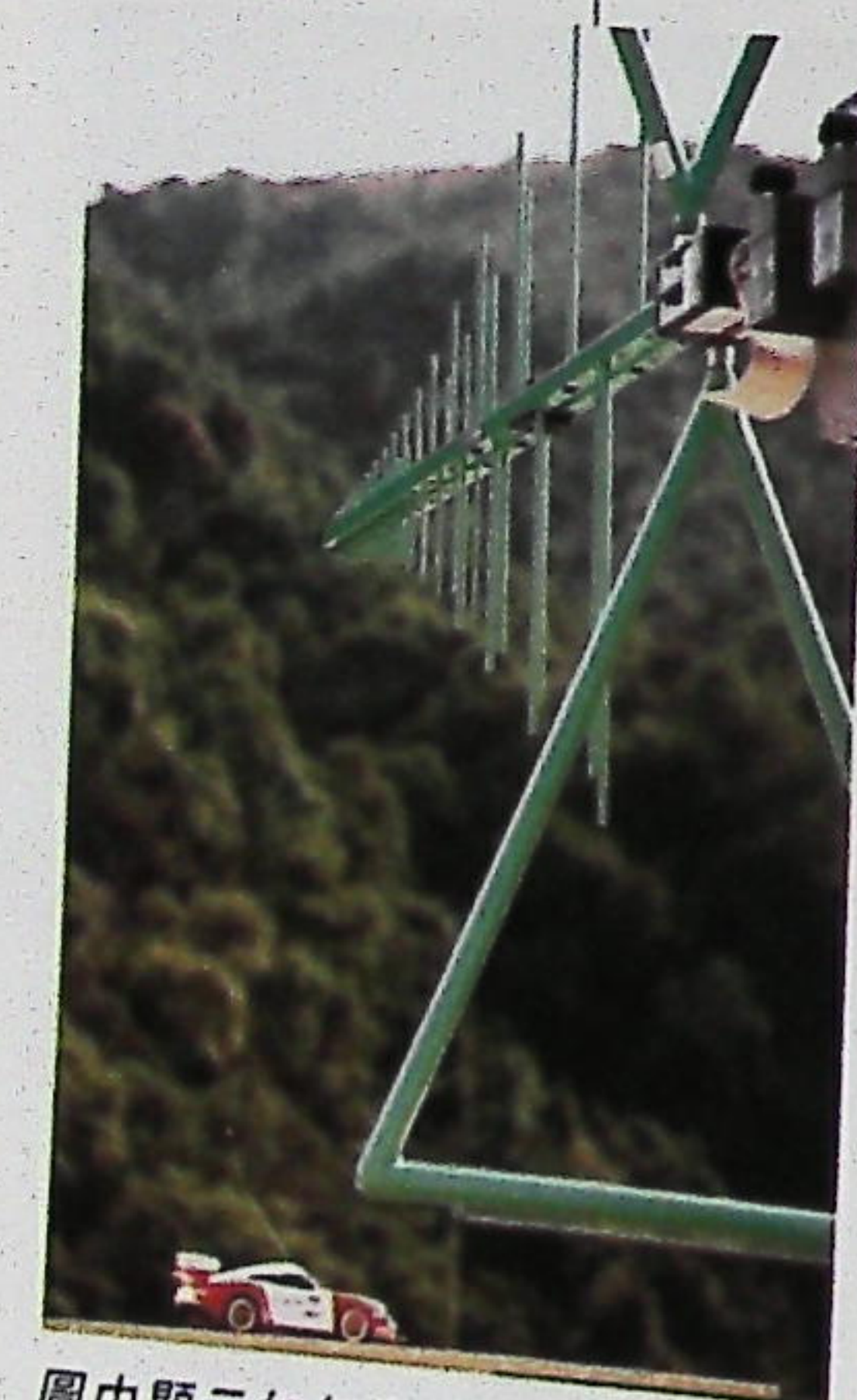
圖中顯示如何測量電動玩具車接收器的輻射。
