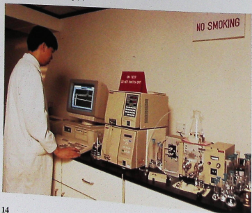
本會鑑定中心提供高次液相層析分析。 CMA Testing & Certification Laboratories provides high performance liquid chromatography.
