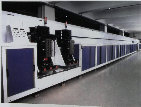
亞洲電腦器材有限公司之 PAL集成電路自動電鍍機 設計：研究及發展部
