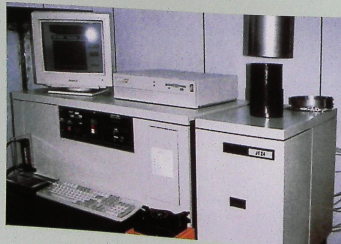
本會檢定中心備有電腦耦合共振發射光譜儀器同軸聲波儀器。 TCL's Inductively Coupled Plasma Spectrometer (ICP) coupled with an Ultrasonic Nebulizer.
