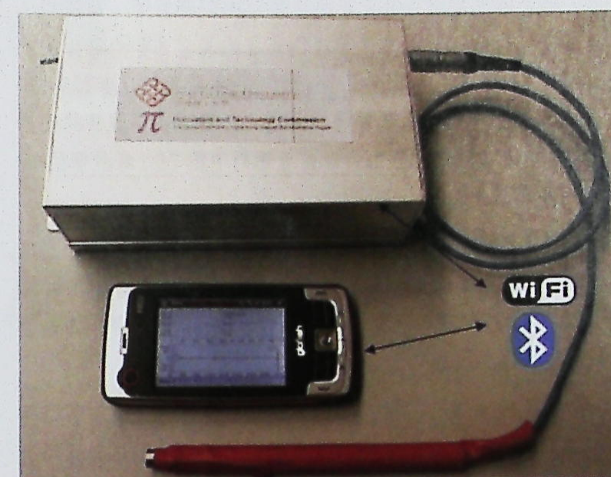
以 PDA 為基礎的組織硬度超聲波傳感器。
