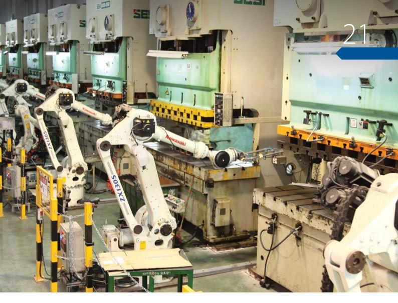
嘉利國際控股有限公司,成立於 1980年,主要從事五金塑膠及電子 專業代工業務。集團在2007年開始 研發自動化生產,並在2011年引入 28台六軸機械臂,嘗試五金沖壓自 動化。
