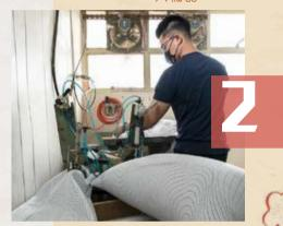
将枕頭套在機器的出口, 材料注滿枕頭
