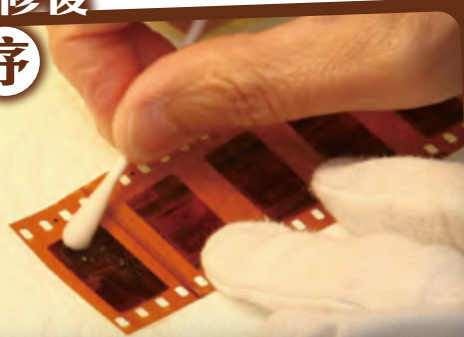
電影修復員使用棉花棒清理菲林上的油垢、灰塵和殘餘化學物質等，再以高濃度酒精和尤加利油徹底清理
