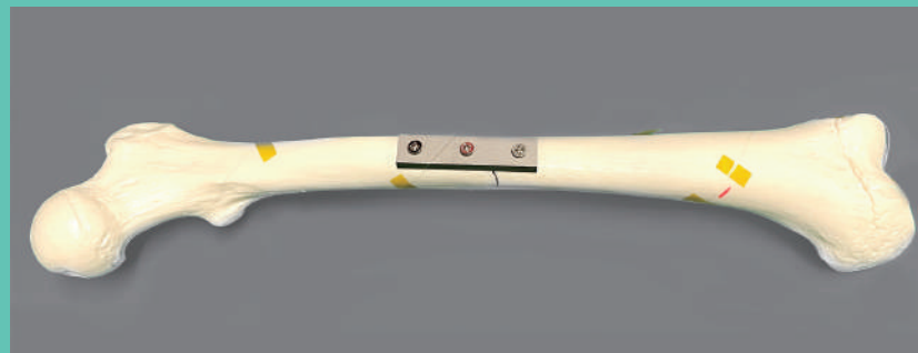
安裝了超微細光纖傳感器的矯形外科植入物，適用於骨骼康復進度監察。 An orthopaedic implant with microsensors for monitoring bone fracture recovery
